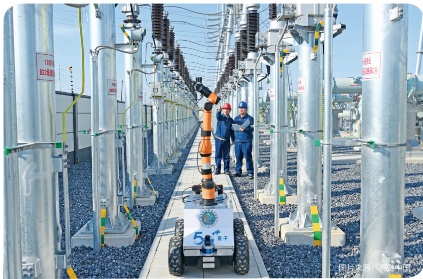
▲ 技术创新将持续强化首发经济驱动力机制。通过新兴技术赋能，企业具备快速迭代产品、优化服务体验的能力，从而满足日益分化的个性化消费需求。图为搭载DeepSeek大模型的智能巡检机器人在安徽滁州某变电站内校准数据。
